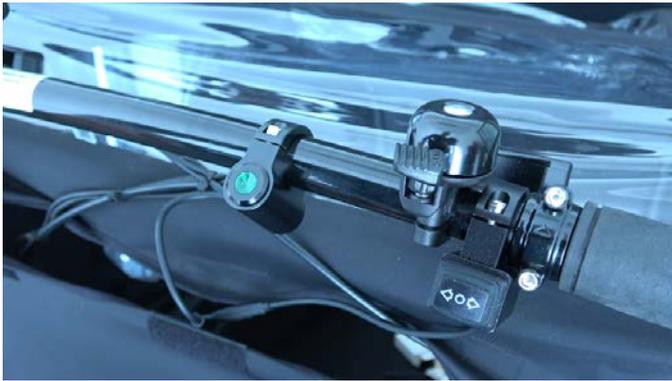
Abb. 2 Schalter und Status LED am Lenker
