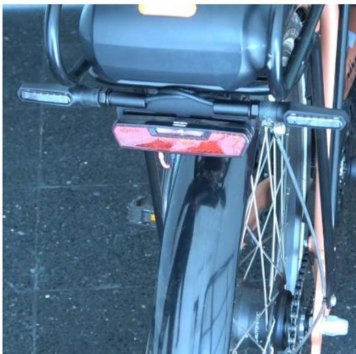
Abb. 12 Montageposition Blinkerhalterung am Rücklicht
