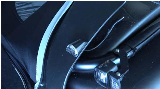
Abb. 7 Blinkerposition an der Cargobox
