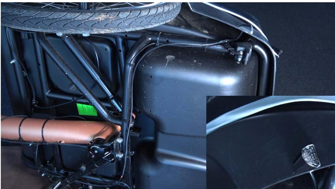
Abb. 9 Kabelführung der Blinker
