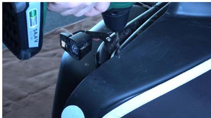
Abb. 6 Bohren der Kabeldurchführung
