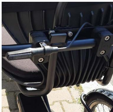
Zuerst sollten die Blinkerhalterungen BHW1 für die hinteren Blinker montiert werden. Dazu wird die Armlehne des Disco benötigt.
