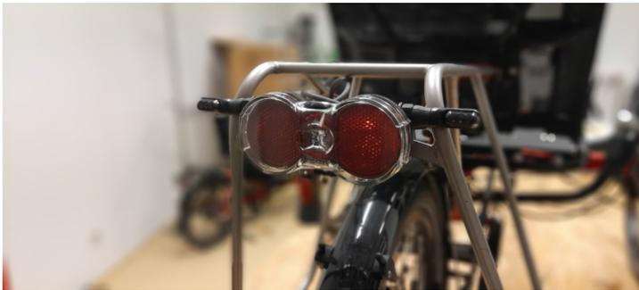
Zuerst sollten die Blinkerhalterungen für die hinteren Blinker montiert werden. Das Bild zeigt die Montage am Gepäckträger.
