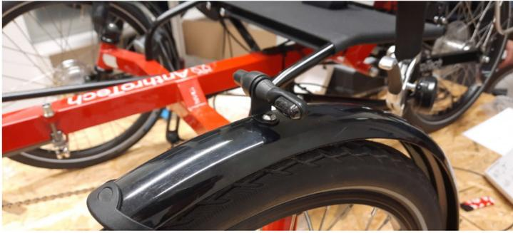
Für die Montage der Blinker werden die Schutzbleche abmontiert und auf den oberen Befestigungsschrauben die Montagewinkel für die Blinker befestigt. Zur Befestigung ist die (kleinere) M6 Bohrung des Winkels gedacht.
