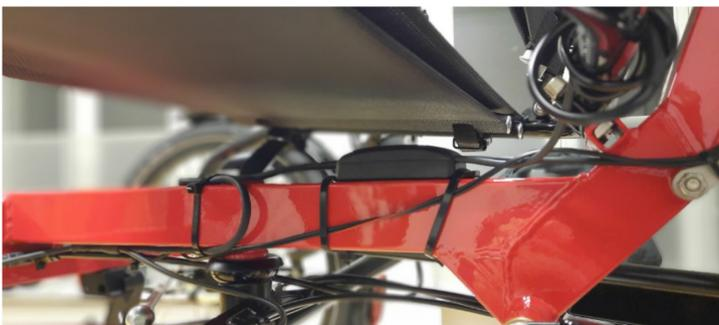
Der vorgesehene Montageort für die Blinkerbox ist unter dem Sitz auf dem Rahmen. Dort sollte sie zuerst provisorisch befestigt werden.
