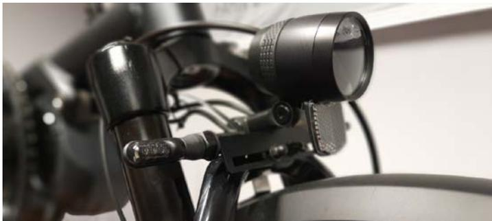
Für die Montage der vorderen Blinker an der Federgabel werden diese in die GBHV3 eingeschraubt und mit dem Montagewinkel auf der Federgabel befestigt. Der Montagewinkel wird dabei mit 2 Schrauben an der GBHV3 befestigt und auf der anderen Seite mittig mit dem Scheinwerfer festgeschraubt.
