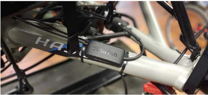
Der vorgesehene Montageort für die Blinkerbox ist auf der Hinterradschwinge. Dort sollte sie zuerst provisorisch befestigt werden.
